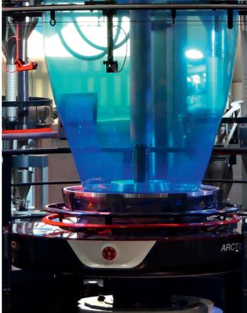
**Bild 1.** Show-Betrieb: Auf der K erreichte die Vorex II dank ihres neuen Hochleistungskühlsystems einen Spitzenwert von 1559 kg/h Durchsatz
